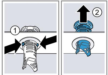
5. Unter fließendem Wasser die Siebelemente reinigen.
