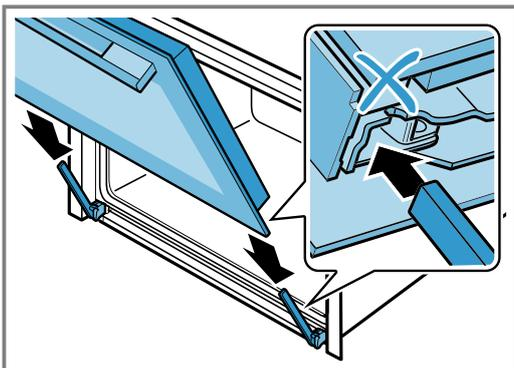
2. Mit beiden Händen von oben links und rechts auf die Türabdeckung drücken, um zu prüfen, ob die Gerätetür bis zum Anschlag eingeschoben ist.
