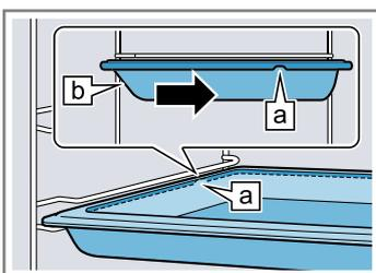
3. Um das Zubehör bei Einschubhöhen mit Auszugsschienen aufzulegen, die Auszugsschienen herausziehen.
