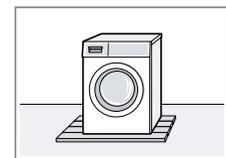
Colocar el aparato sobre una tabla de madera resistente al agua (mín. de 30 mm de grosor) que esté firmemente atornillada al suelo.
