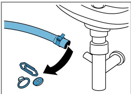
5. Enfichez le tuyau d'évacuation d'eau et sécurisez le point de raccordement à l'aide du collier de serrage.
