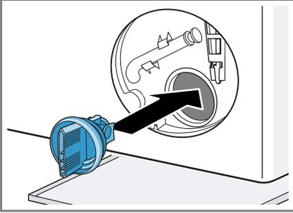
5. Insérez le couvercle de la pompe et fermez-le jusqu'en butée.
