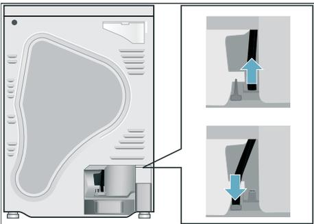
4. Nehmen Sie den Ablaufschlauch aus dem Zubehör und befestigen diesen am leeren Stutzen. Drücken Sie den Ablaufschlauch in die Schlauchführung.
