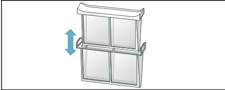
5. Klappen Sie beide Siebe auf und entfernen alle Flusen.
