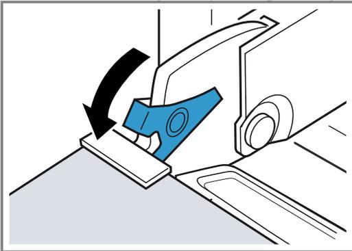
3. Die Gerätetür schließen, so dass die Gerätetür um ca. 30 ° geöffnet bleibt.
