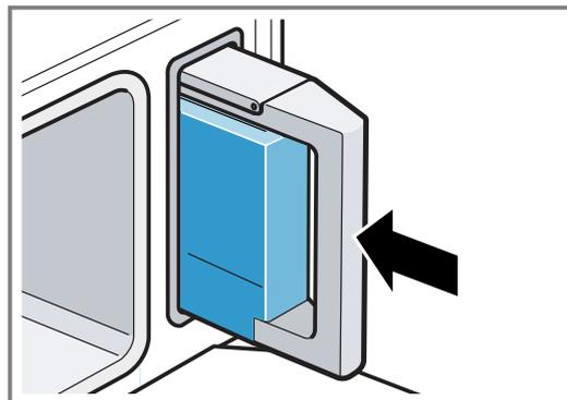
6. Überprüfen, ob der Wassertank bündig mit dem Tankschacht sitzt.
