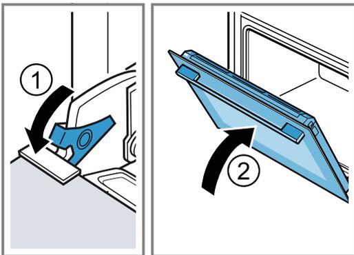
4. Appuyez sur le recouvrement de la porte à gauche et à droite à l'extérieur de la porte de l'appareil ① jusqu'à ce qu'il se débloque.
