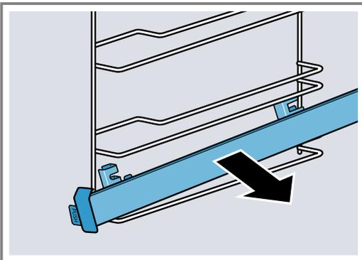
5. Die Auszugsschiene reinigen.
