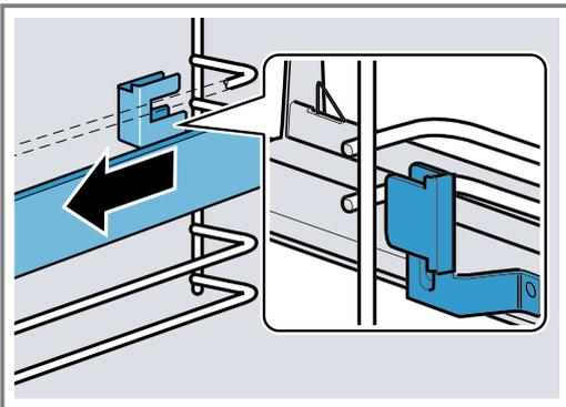
4. Die Auszugsschiene entfernen.
