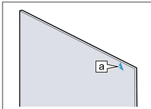
2. Die Zwischenscheibe unten in die Halterung [a] einsetzen ① und oben andrücken und festhalten.
