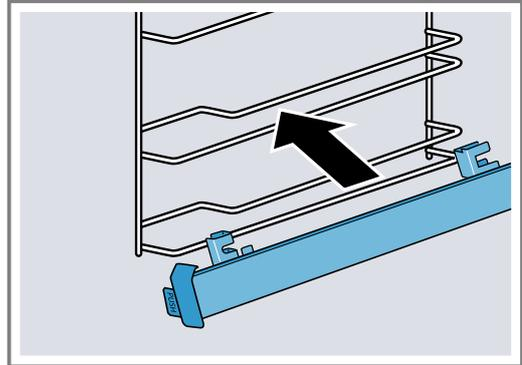
2. Die Halterung [a] hinten zwischen dem unteren und oberen Stab einführen.
