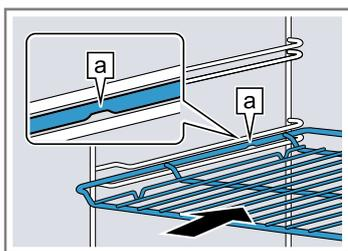
Blech z. B. Universalpfanne oder Backblech Das Blech mit der Abschrägung
