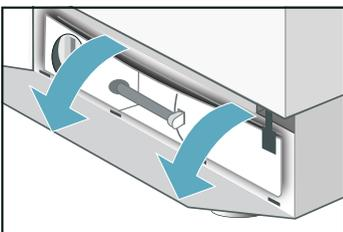
3. Entleerungsschlauch aus der Halterung nehmen. Die Verschlusskappe entfernen und das Wasser in einen geeigneten Behälter auslaufen lassen. Der Behälter für das abgelassene Wasser muss gegebenenfalls mehrmals entleert werden. Verschlusskappe aufdrücken und Entleerungsschlauch in die Halterung einsetzen.
