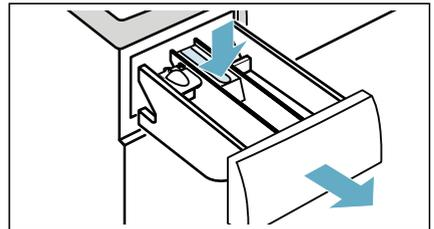
2. Dosierhilfe nach vorn schieben, herunterklappen und einrasten.
