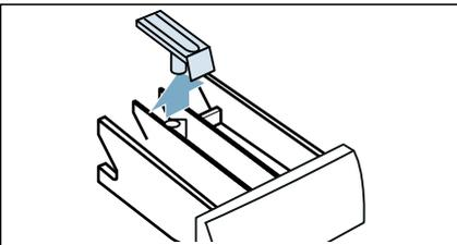
3. Einspülschale und Einsatz mit Wasser und Bürste reinigen und abtrocknen. Auch Gehäuse innen reinigen.
