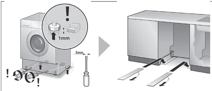
Gleitbleche erleichtern das Einschieben der Waschmaschine in die Einbaunische.
