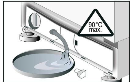
4. Den Pumpendeckel vorsichtig abschrauben. Dabei kann Restwasser auslaufen. Das Pumpengehäuse reinigen und etwaige Fremdkörper entfernen. Das Flügelrad der Laugenpumpe muss sich drehen lassen.
