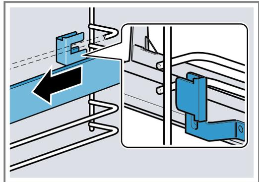
4. Die Auszugsschiene entfernen.
