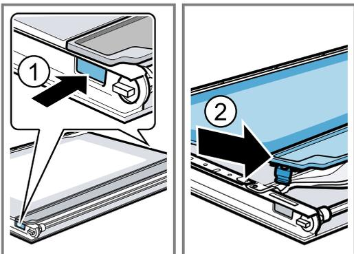
4. Die Zwischenscheibe im Bereich [a] nach unten drücken und die Halterung [b] vorsichtig anheben, bis sie sich herausziehen lässt.
