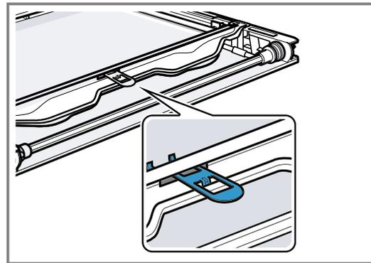
6. Die Innenscheibe schräg nach hinten in die Befestigungsschiene ① einsetzen ①.
