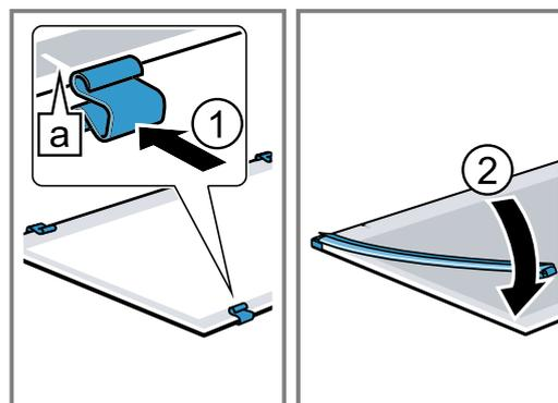
3. Die Zwischenscheibe mit Abstandshalter und Dichtungen in Pfeilrichtung einsetzen ①. Der Pfeil auf der Zwischenscheibe muss mit dem Pfeil auf dem Rahmen übereinstimmen [a].
