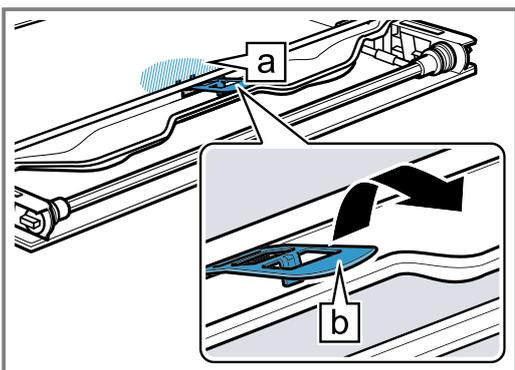
5. Die erste und zweite Zwischenscheibe von unten anheben ① und in Pfeilrichtung herausnehmen ②.
