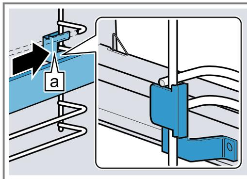
3. **PUSH** gedrückt halten ① und die Auszugsschiene nach innen schwenken, bis sich die Halterung **a** vorn zwischen den beiden Stäben befindet ②.
