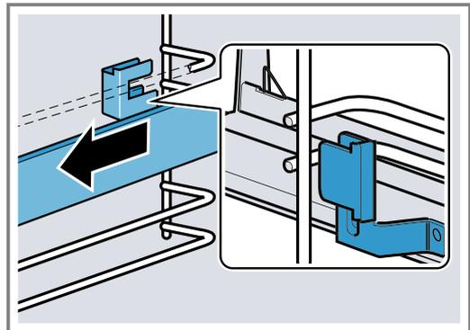
4. Die Auszugsschiene entfernen.
