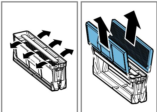
2. Het vetfilter los in de vaatwasmachine plaatsen en niet inklemmen.
