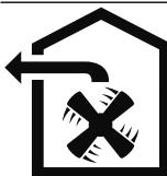
De lucht mag niet worden afgevoerd in een schoorsteen die wordt gebruikt voor afvoergassen van apparaten bestemd voor het verbranden van gas of andere brandstoffen (dit geldt niet voor ventilatieapparatuur).
