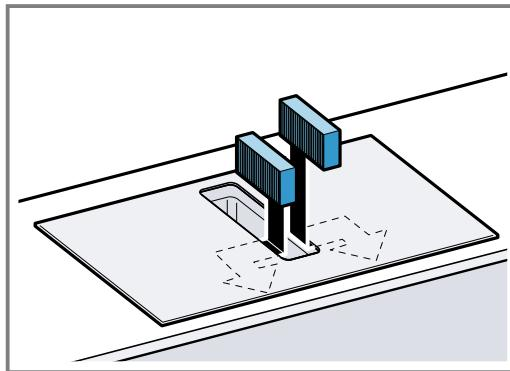
5. De andere geurfilters of akoestische filters links en rechts in het apparaat plaatsen.
