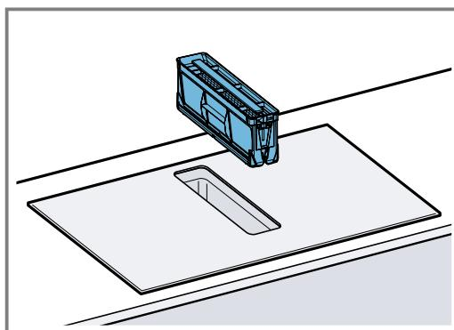
3. De 4 geurfilters of akoestische filters eruit halen en correct afvoeren.
