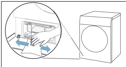
6. Umetak izvucite vodoravnim povlačenjem.
