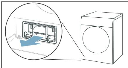
8. Otvor uređaja očistite mekom, vlažnom krpom.
