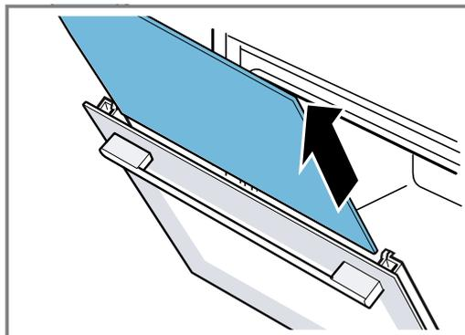
8. Bei Bedarf können Sie die Kondensatleiste zum Reinigen herausnehmen.
