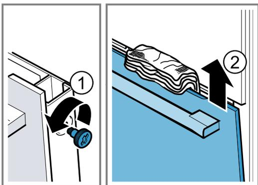
7. Extrayez la vitre frontale par en haut et déposez-la sur une surface plane, la poignée de porte orientée vers le bas.
