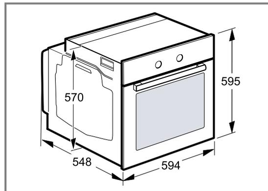
**23.3 Einbau unter einer Arbeitsplatte**
