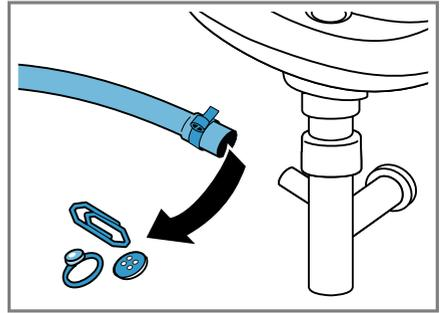
5. Den Wasserablaufschlauch aufstecken und die Anschlussstelle mit der Schlauchschelle sichern.
