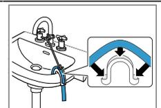
Ablauf in ein Kunststoffrohr mit Gummimuffe.
