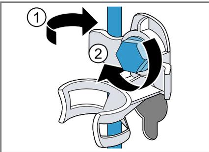
5. Den Schlauch in die Halterung einsetzen.
