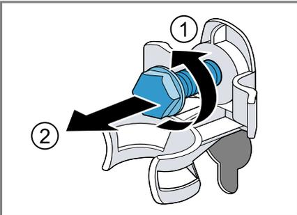
3. Die Netzanschlussleitung aus der Halterung ziehen.
