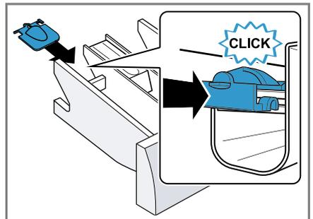
4. Die Waschmittelschublade einsetzen.
