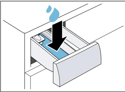
5. Das Pulvervollwaschmittel in die Kammer II einfüllen.
