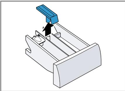
4. Die Waschmittelschublade und den Einsatz mit Wasser und Bürste reinigen und abtrocknen.
