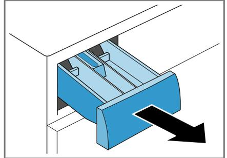
2. Den Einsatz runterdrücken und die Waschmittelschublade entnehmen.
