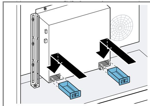
**14.** Die Kabel am Lüfterkasten einstecken.
