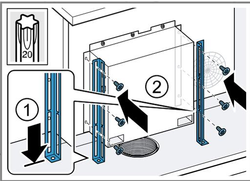
10. Am Schrankboden die Schienen festschrauben.
