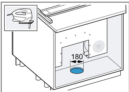
6. Glissez le boîtier du ventilateur dans le guide, créez le conduit d'évacuation extérieure et vissez le boîtier du ventilateur.
