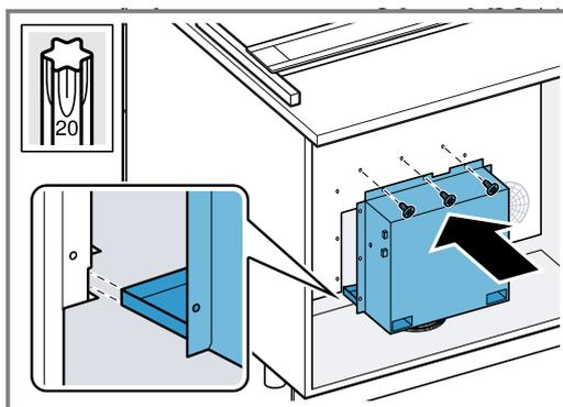
7. Soutenez l'appareil par le bas et retirez les baguettes.
