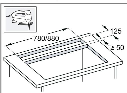
Det må være 90° vinkel på snittflaten i forhold til benkeplaten.
