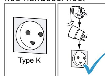
Fagligt ukorrekt tilslutning af apparater over 13 A/3 kW er farlig. Angivelserne om dette apparats effekt findes på typeskiltet → "Produktnummer (E-Nr.) og fabrikationsnummer (FD-Nr.)", Side 75
