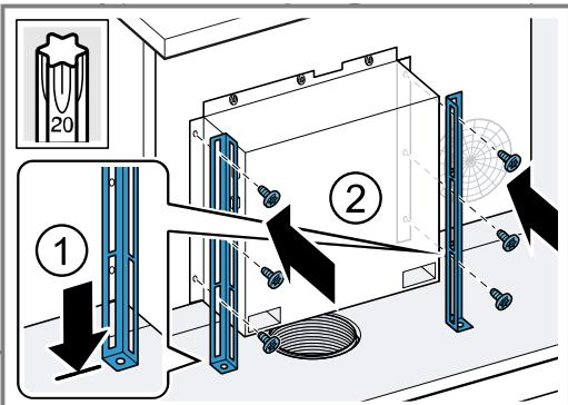
10. Skruva fast skenorna på stombotten.
