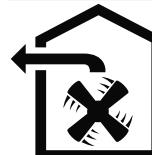
Poistoilmaa ei saa johtaa hormiin, jota käytetään kaasua tai muita poltoaineita polttavien laitteiden pakokaasun poistoon (tämä ei koske kiertoilmalaitteita).
