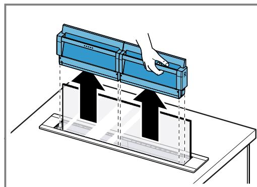
3. Asenna rasvasuodattimet paikoilleen rasvasuodatinkasetteihin. Älä taivuta rasvasuodattimia, jotta vältät vaurioit.
