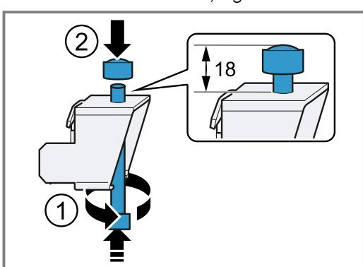
**12.** Indjuster apparatet i forhold til kogesektionen ①, og spænd det fast mod bordpladen ② ③.
