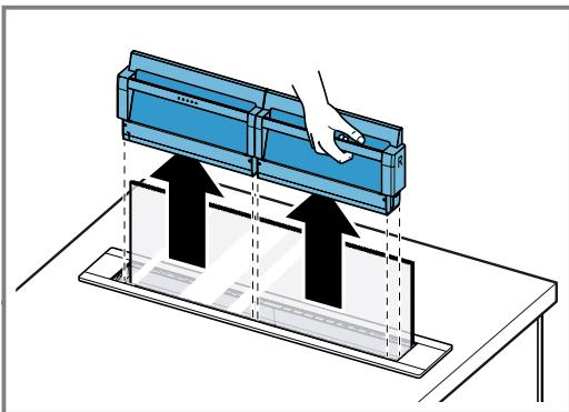
3. Sæt fedtfiltrene på plads i fedtfilterkassetten.
