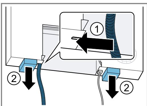
3. **Bemærk:** Læg en liste under de korte sider af apparatet, så det endnu ikke bliver sat fuldstændigt ned i udsparingen.
