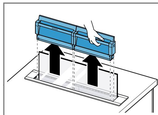
3. Sätt i metallfiltren i filterkassetterna.
