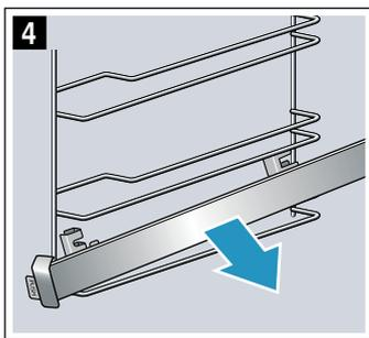
Reinigen Sie die Auszugsschienen mit Spülmittel und einem Spülschwamm. Bei hartnäckigen Verschmutzungen verwenden Sie eine Bürste.
