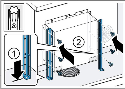
11. Am Schrankboden die Schienen festschrauben.
