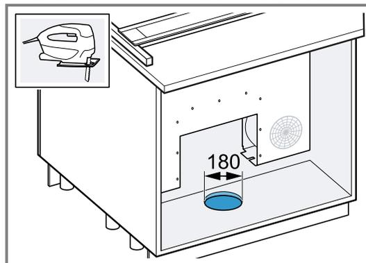
7. Den Lüfterkasten in die Führung schieben, die Verrohrung herstellen und den Lüfterkasten festschrauben.
