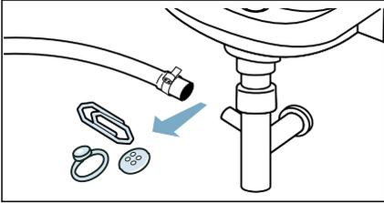
4. Τοποθετήστε ξανά τον εύκαμπο σωλήνα άντλησης και ασφαλίστε το σημείο σύνδεσης χρησιμοποιώντας τον σφιγκτήρα του εύκαμπτου σωλήνα.
