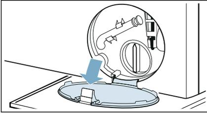
3. Ελευθερώστε τον εύκαμπο σωλήνα αποχέτευσης από τον σφιγκτήρα συγκράτησης. Αφαιρέστε το πώμα στεγανοποίησης και χύστε το νερό σε ένα κατάλληλο δοχείο. Επανατοποθετήστε το πώμα στεγανοποίησης και τοποθετήστε τον εύκαμπο σωλήνα αποχέτευσης ξανά στον σφιγκτήρα συγκράτησης.
