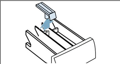
3. Limpe o dispensador de detergente e o dispositivo com água e uma escova, e seque-os. Limpe também o interior da caixa.
