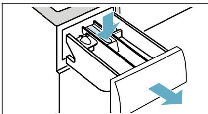
2. Desloque o auxiliar de medição para a frente, dobre-o e encaixe-o no lugar.
