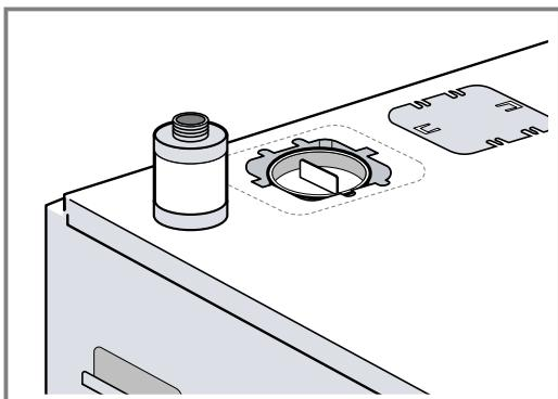
2. Retirez la cale de transport pour la pompe sur la face supérieure de l'appareil.
