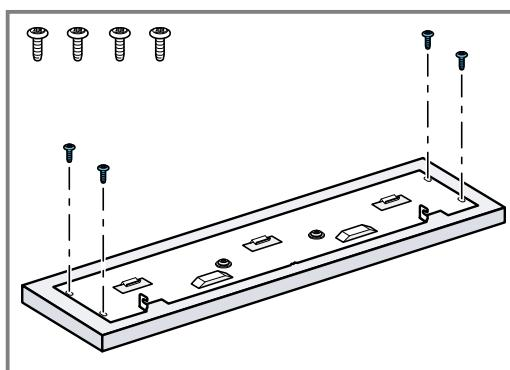
21. Het meubelfront met de frontplaat aan het apparaat inhangen.
