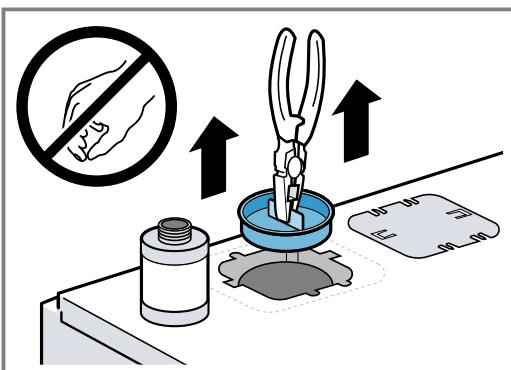
3. Die Transportsicherung zur weiteren Verwendung an der Geräterückseite befestigen.
