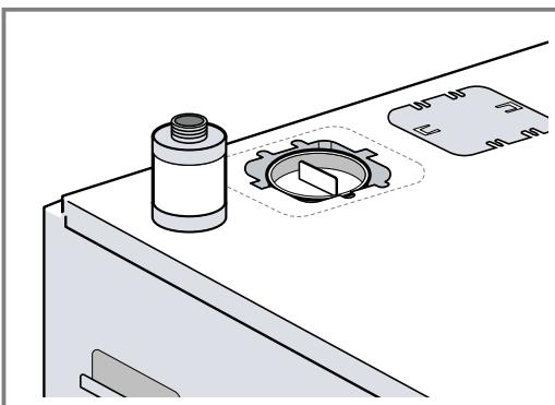
2. Retirar el seguro de transporte para la bomba de la parte superior del aparato.
