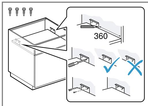
2. Die Befestigungswinkel mit der Montagehilfe am Möbel befestigen.
