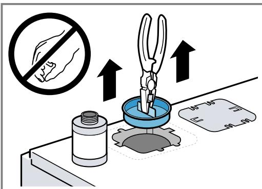
3. De transportbeveiling voor het verdere gebruik aan de achterkant van het apparaat bevestigen.
