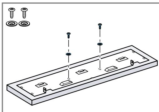
19. Volver a colocar la chapa frontal sobre el frontal del mueble.
