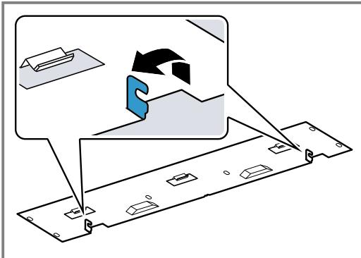
3. Montar la chapa frontal en el aparato y presionarla hacia abajo hasta el tope.
