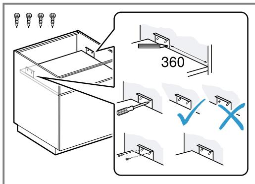
2. Fijar los ángulos de fijación con la ayuda para la instalación en el mueble.
