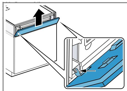
10. Controllare la posizione del pannello frontale sul frontale del mobile.
