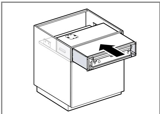
3. Si l'appareil ne peut pas être inséré, réglez la sécurité anti-basculement en hauteur. Pour ce faire, dévissez les vis et poussez la sécurité anti-basculement vers le haut.
