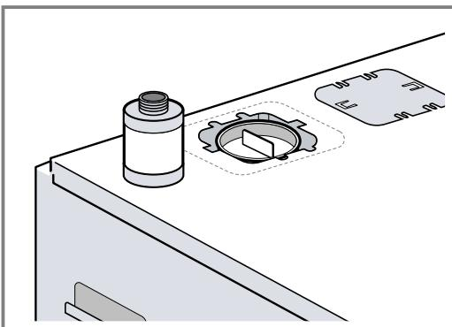
2. Die Transportsicherung für die Pumpe auf der Geräteoberseite entfernen.
