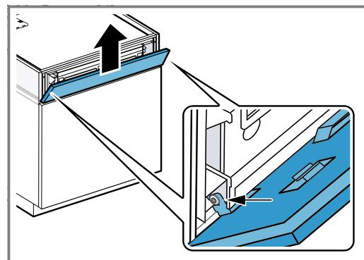
10. Comprobar el soporte de la chapa frontal del frontal del mueble.
