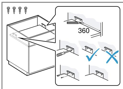
2. Fissare le squadrette di fissaggio al mobile servendosi dell'ausilio di montaggio.
