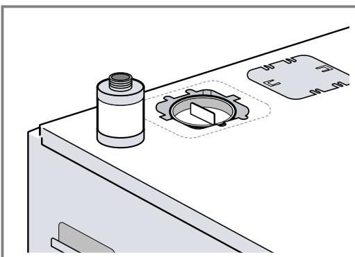
2. De transportbeveiling voor de pomp aan de bovenkant van het apparaat verwijderen.
