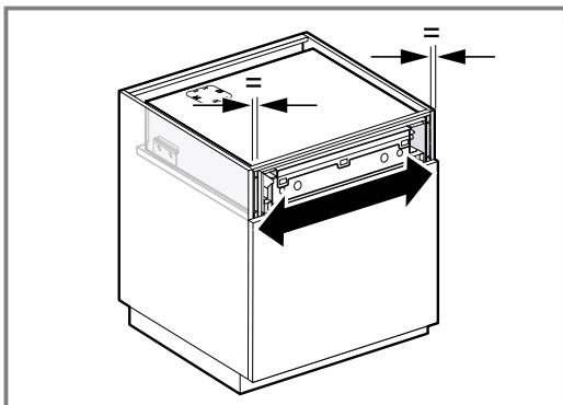
5. Om de kantelbeveiling te controleren, de lade voorzichtig openen.
