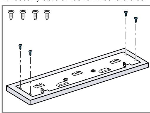
21. Montar el frontal del mueble en el aparato con la chapa frontal.
