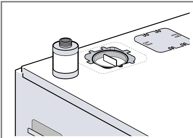
2. De transportbeveiliging voor de pomp aan de bovenkant van het apparaat verwijderen.
