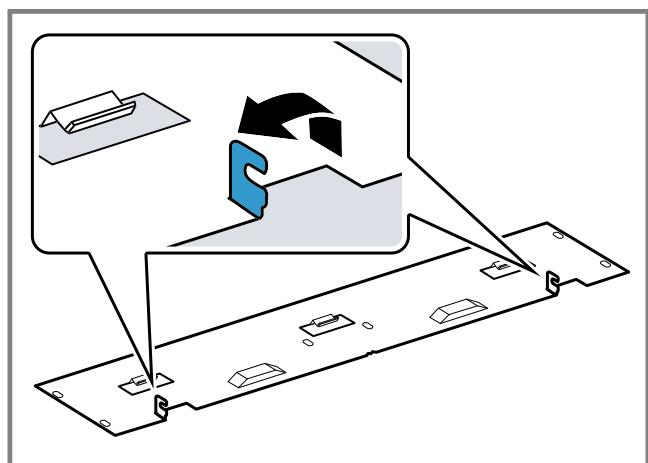
3. Accrochez la tôle frontale à l'appareil et appuyez dessus jusqu'en butée.
