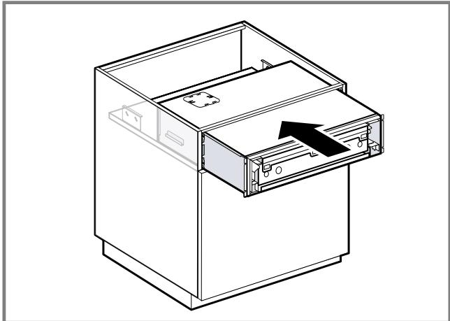
3. Si no es posible introducir el aparato, ajustar el ángulo del seguro contra vuelco en altura. Para ello, aflojar los tornillos y colocar el ángulo del seguro contra vuelco hacia arriba.
