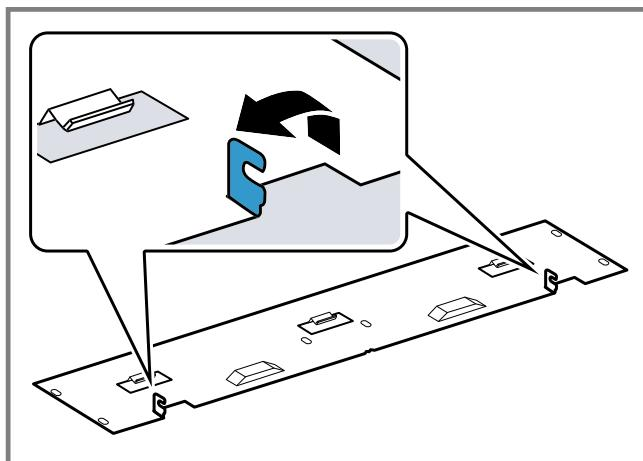
3. Das Frontblech am Gerät einhängen und bis zum Anschlag nach unten drücken.
