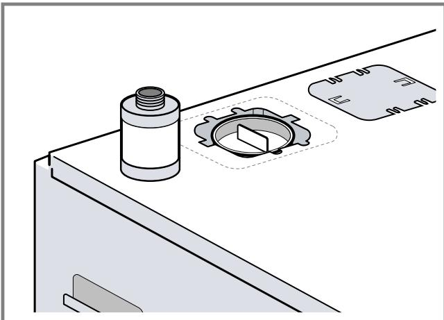
2. Retirar el seguro de transporte para la bomba de la parte superior del aparato.
