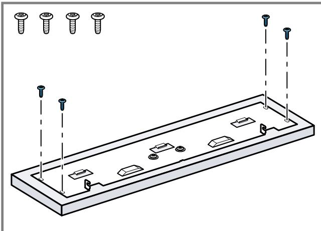
21. Het meubelfront met de frontplaat aan het apparaat inhangen.
