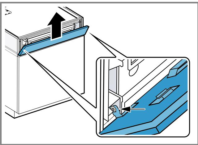
10. Comprobar el soporte de la chapa frontal del frontal del mueble.
