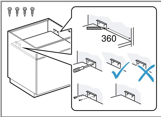
2. Fissare le squadrette di fissaggio al mobile servendosi dell'ausilio di montaggio.
