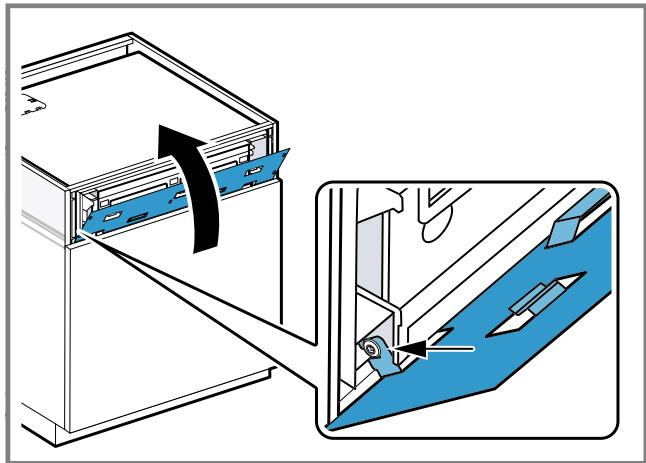
4. Controleren of de frontplaat recht is ingehangen.
