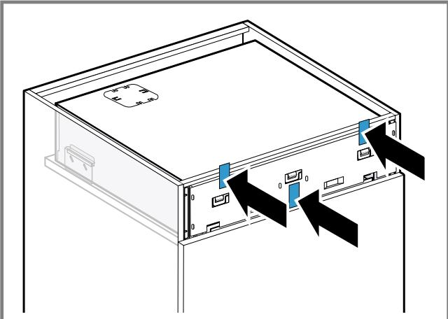
6. Nivelar el frontal del mueble y presionar la chapa frontal.
