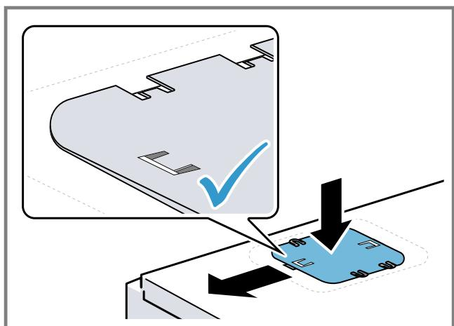
6. **AVVERTENZA – Pericolo di ribaltamento!** Dopo la rimozione del blocco per il trasporto si può aprire il cassetto e ribaltare l'apparecchio.
