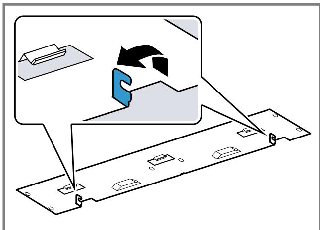
3. De frontplaat aan het apparaat inhangen en tot aan de aanslag naar onderen drukken.
