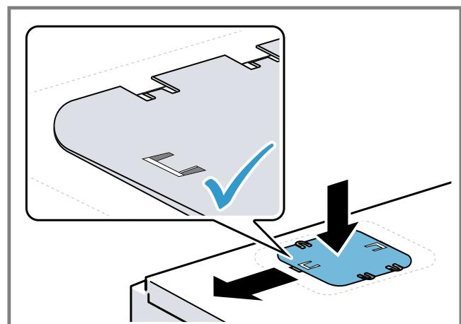
6. **WAARSCHUWING – Kantelgevaar!** Na het verwijderen van de transportbeveiling kan de lade open gaan en het toestel doen kantelen.
