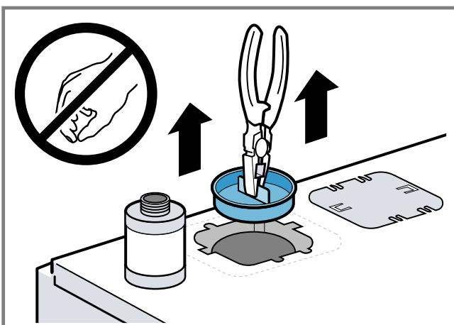
3. De transportbeveiliging voor het verdere gebruik aan de achterkant van het apparaat bevestigen.
