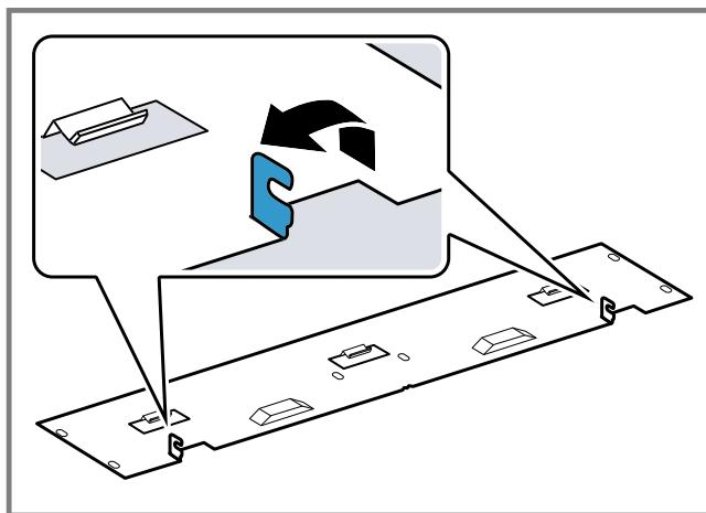
3. Montar la chapa frontal en el aparato y presionarla hacia abajo hasta el tope.
