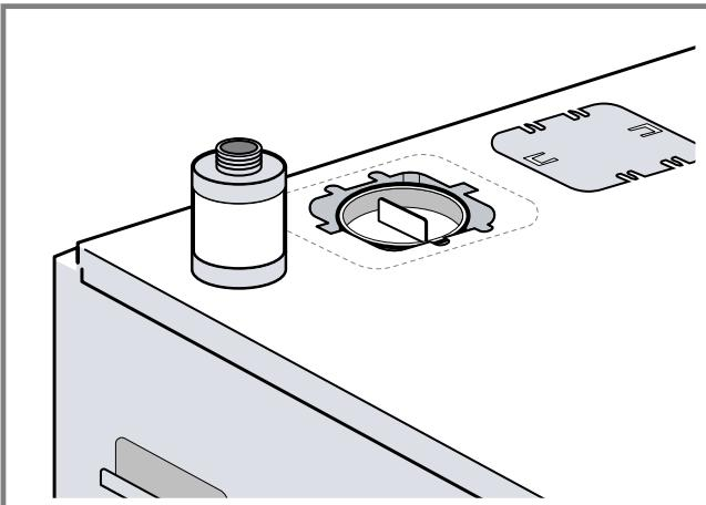
2. Die Transportsicherung für die Pumpe auf der Geräteoberseite entfernen.
