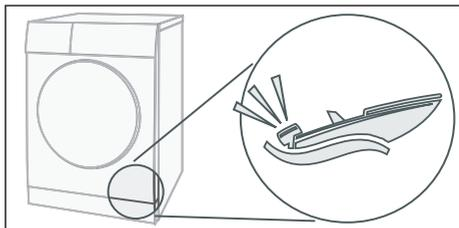
Kompresor se s vremena na vreme provetrava i pri tome nastaje zujeći šum.
