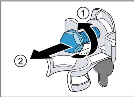
3. Die Netzanschlussleitung aus der Halterung ziehen.
