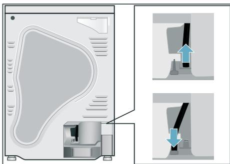
4. Retirez le flexible d'écoulement des accessoires et fixez-le sur le manchon libre. Enfoncez le flexible d'écoulement dans le guidage de flexible.
