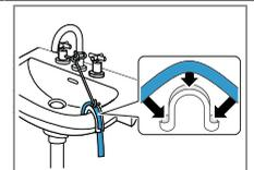
Ablauf in ein Kunststoffrohr mit Gummimuffe.
