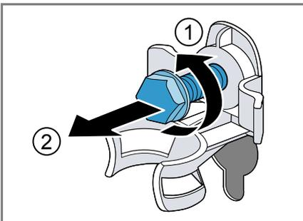
3. Die Netzanschlussleitung aus der Halterung ziehen.
