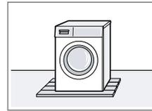
Das Gerät auf einer wasserbeständigen Holzplatte aufstellen, die fest mit dem Fußboden verschraubt ist. Die Stärke der Holzplatte sollte mindestens 30 mm betragen.
