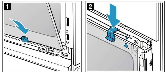
3. Introducir el cristal delantero por abajo en las sujeciones (figura 3).
