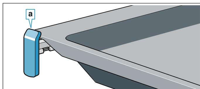
Los rieles de extracción se enclavan cuando están totalmente extraídos. De esta manera, el accesorio puede colocarse fácilmente. Para desenclavarlos, volver a introducir los rieles de extracción en el interior del aparato ejerciendo un poco de presión.
