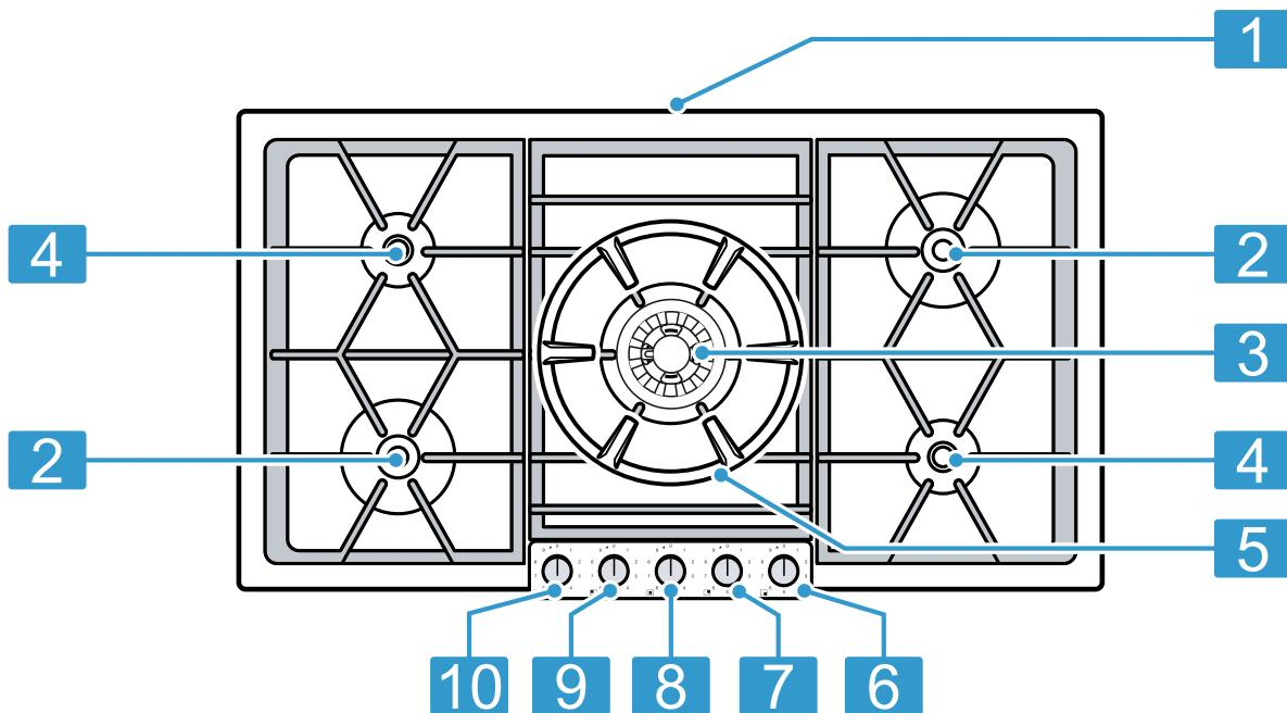
**1** Lüftungsöffnungen unter den Topfrägern
