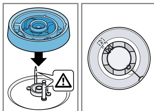
4. Die Rastnase am Brennring in der Aussparung am Brennerkopf einrasten.
