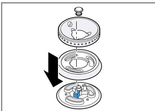
Die Ausrichtung von Brennerkopf und Brennring ist egal.
