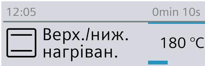
На дисплеї відображається налаштований вид нагрівання та температура.
