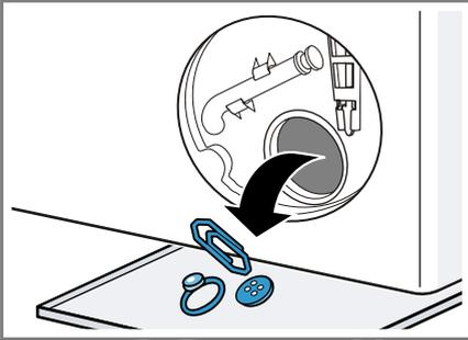
Der Pumpendeckel besteht aus zwei Bauteilen die zur Reinigung auseinandergebaut werden können.
