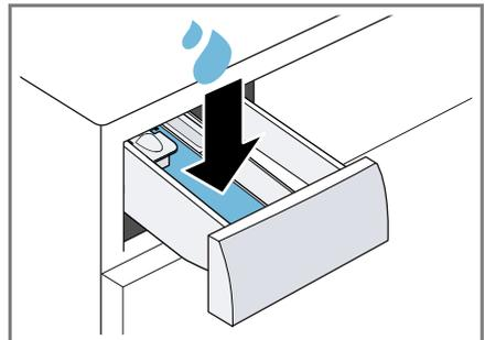
6. Das Pulvervollwaschmittel in die Kammer II einfüllen.
