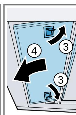
3. Retirez les filtres à graisse des fixations.
