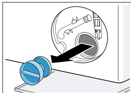
2. Limpe o interior, a rosca da tampa da bomba e a estrutura da bomba.
