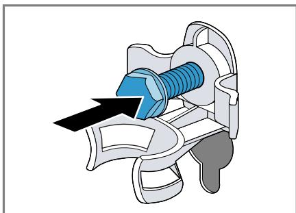
**4.** Insira o cabo de ligação no suporte ① e aperte os 4 parafusos dos dispositivos de segurança para transporte com uma chave tam. 13 ②.
