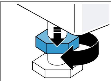
2. Rodar os pés reguláveis para nivelar o aparelho. Verificar o nivelamento com nível de bolha de ar.
