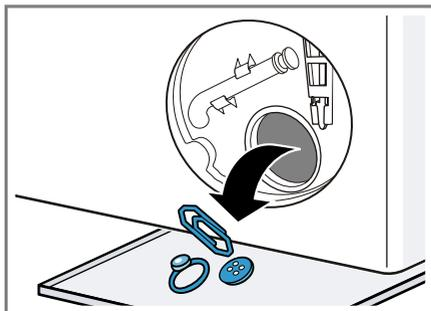
3. Assegure que a roda de pás da bomba de escoamento gira livremente.
