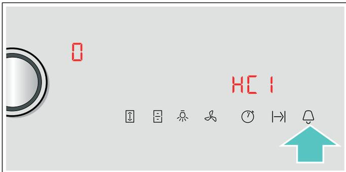
4. Mit dem Twist-Knopf Wert **1** "Automatisch verbinden" oder Wert **2** "Manuell verbinden" einstellen.
