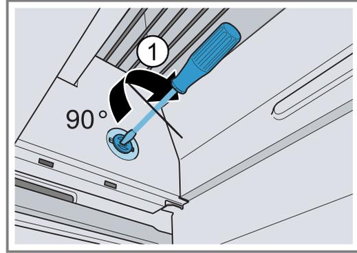
8. Premere leggermente i bulloni di fissaggio con le dita e ruotarli finché non si riescono ad estrarre completamente con la molla dall'alloggiamento. Sollevare leggermente l'apparecchio e stringere i bulloni di fissaggio finché il dispositivo di arresto non si innesta nel mobile.
