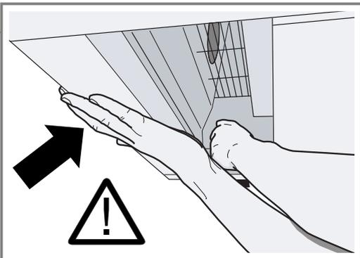
7. Die Befestigungsbolzen mit einem Schlitzschraubendreher eindrücken und um 90° drehen, bis die Befestigungsbolzen ausrasten.
