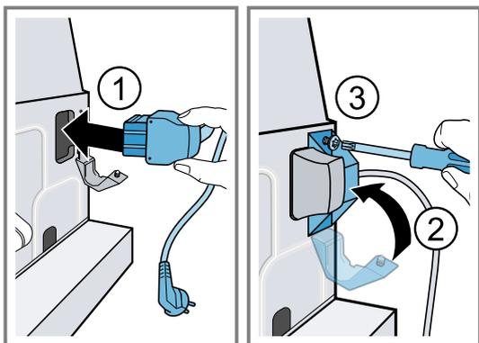
3. Adaptez la baguette murale à la distance entre l'appareil et le mur.
