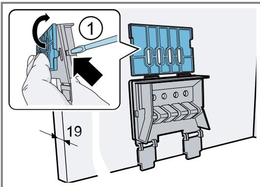
9. Vissez les éléments de fixation à gauche et à droite sur le corps.
