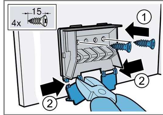
10. Retirez les butées sous les pattes de fixation.
