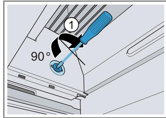
8. Enfoncez légèrement les boulons de fixation avec vos doigts et tournez jusqu'à ce que les boulons de fixation sortent du boîtier. Soulevez légèrement l'appareil et tirez sur les boulons de fixation, jusqu'à ce que le loquet de l'armoire soit libéré.
