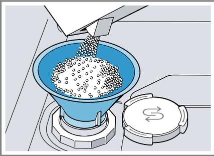
Riempire completamente il serbatoio di sale speciale. L'acqua nel serbatoio trabocca e defluisce.
