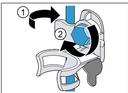
5. Insérez le tuyau dans le support.
