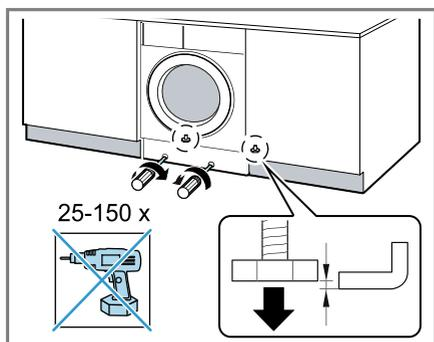
8. Alignez l'appareil à l'aide d'un niveau.
