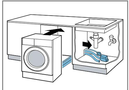
5. Raccordez le tuyau d'arrivée d'eau.
