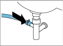
Fixez le point de raccordement avec un collier de serrage (24-40 mm).
