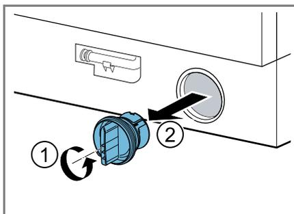
2. Nettoyez le compartiment intérieur, le filetage du couvercle de pompe et le carter de pompe.
