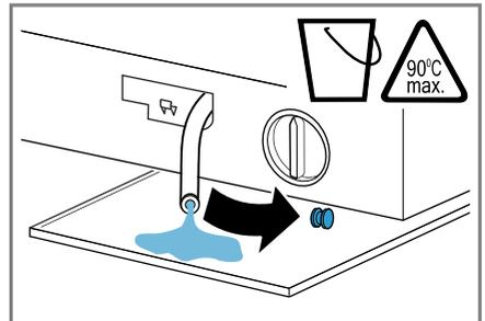
8. Appuyez sur le bouchon de fermeture.
