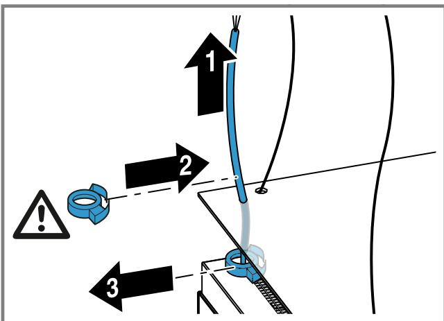
**9. De vier kabels in de kabelspanners inbrengen en gelijkmatig spannen.**
