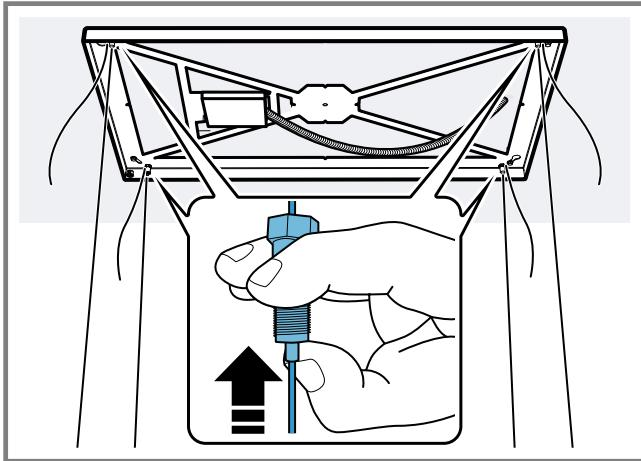
**15.** Infilare la corda dalla copertura del telaio.
