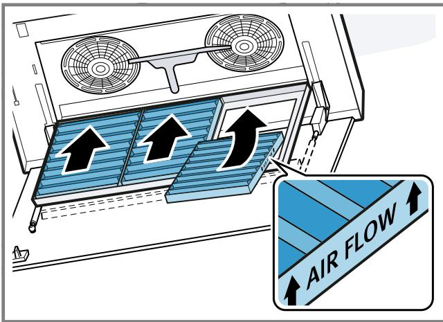
Den Geruchsfilter in korrekter Richtung einsetzen.
