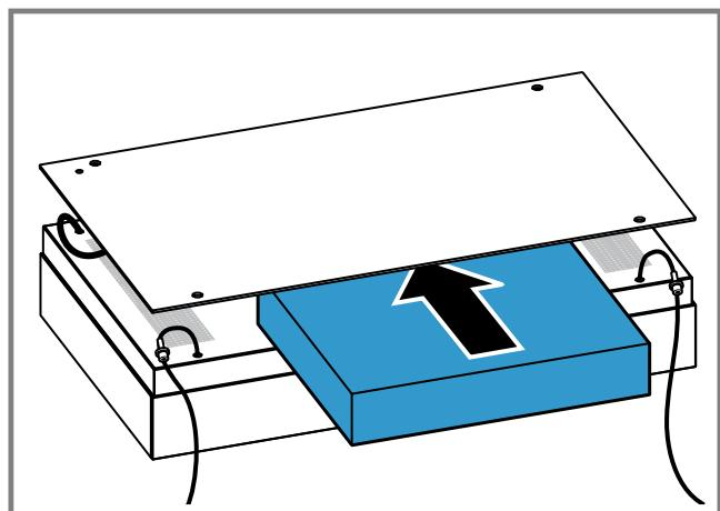
5. De kabels door de openingen van de frameafdekking halen.
