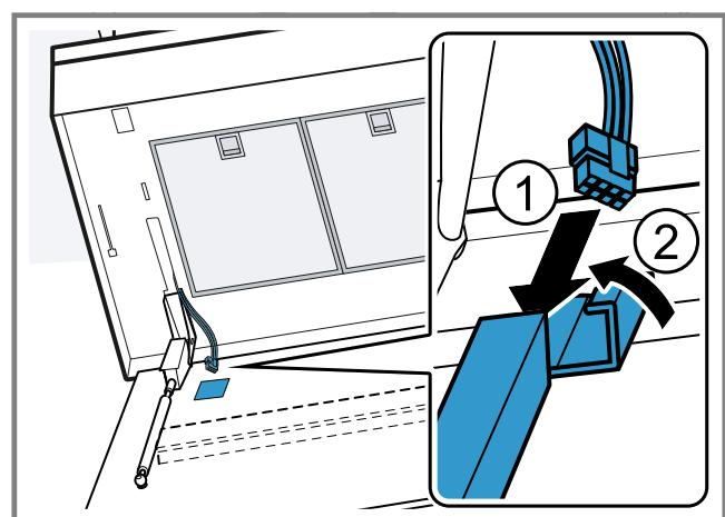
5. Den Deckel des Kabelkanals schließen.
