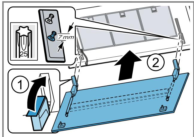
3. De bevestigingsschroeven van de scharnieren aantrekken.
