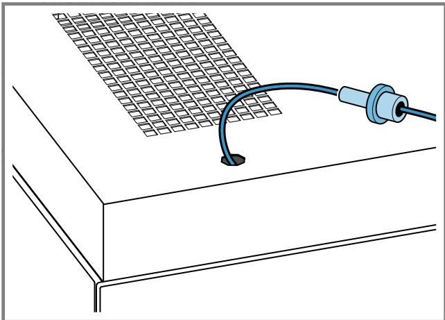
Non inserire i dadi di sicurezza nelle aperture per non danneggiare l'interruttore di finecorsa dell'apparecchio.
