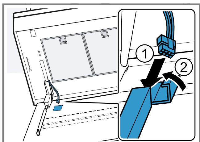
5. Het deksel van de kabelgoot sluiten.
