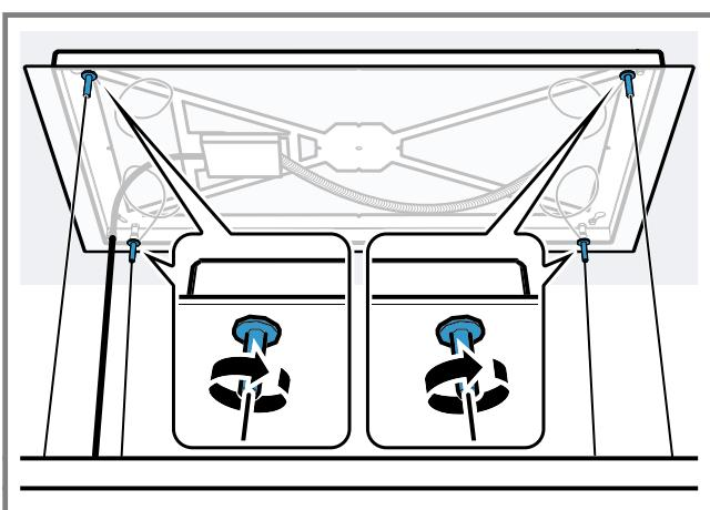
Om de frameafdekking niet te beschadigen, geen gereedschap gebruiken.
