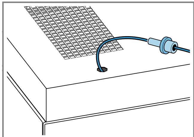
Om de eindschakelaar van het apparaat niet te beschadigen, de sluitmoeren niet in de openingen steken.
