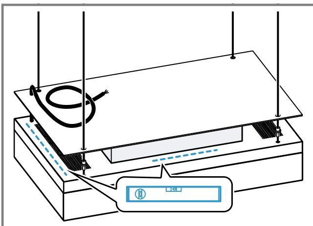
**13.** Die Schutzfolie vom Gerät entfernen.
