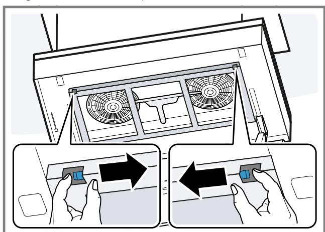
2. De geurfilter verwijderen.
