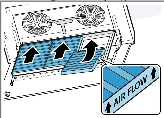
Den Geruchsfilter in korrekter Richtung einsetzen.
