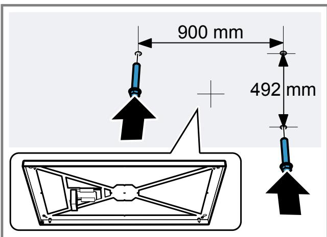
Osservare la corretta posizione delle viti e del telaio.
