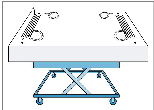
Ne posez pas l'appareil sur les filtres à graisse car ceux-ci pourraient être endommagés.
