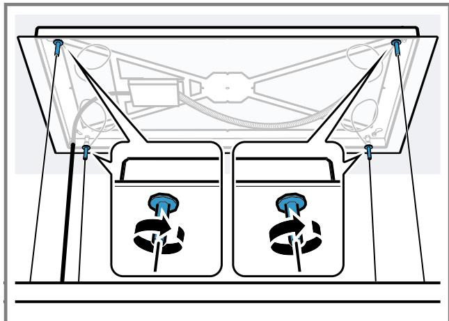
Non utilizzare alcun utensile per non danneggiare la copertura del telaio.
