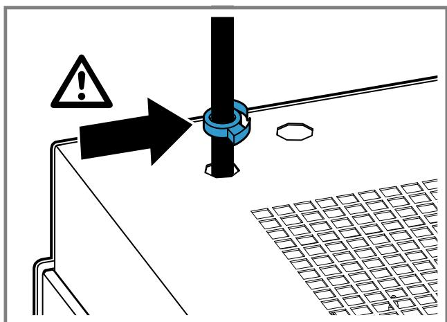
12. Débranchez le câble de la borne de raccordement et retirez le tuyau de protection.
