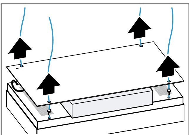
**6.** Allentare il dispositivo di ancoraggio sul cavo sul lato dell'apparecchio ed estrarre il cavo.
