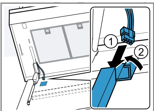
5. Chiudere la copertura della canalina del cavo.
