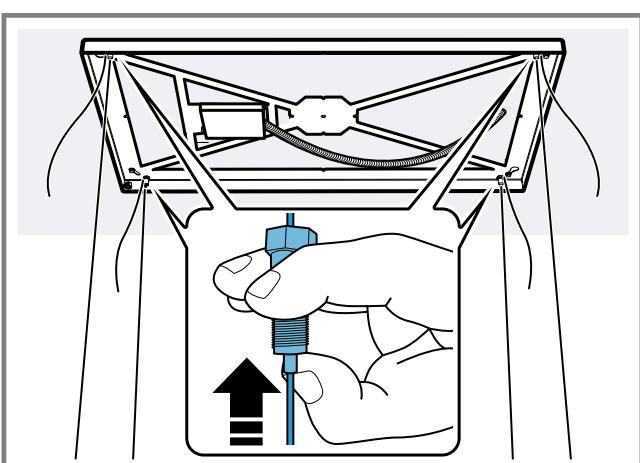
**11. De vier meegeleverde kabelklemmen inbrengen en ca. 20 mm voor de kabelspanners bevestigen.**
