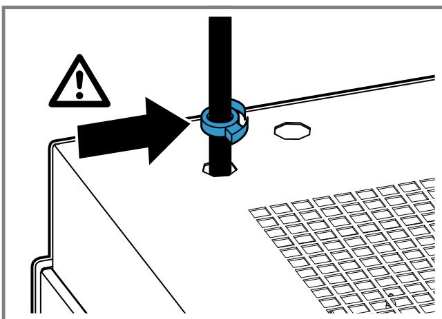
12. Staccare il cavo sul lato di montaggio dal morsetto e rimuovere il tubo flessibile di protezione.
