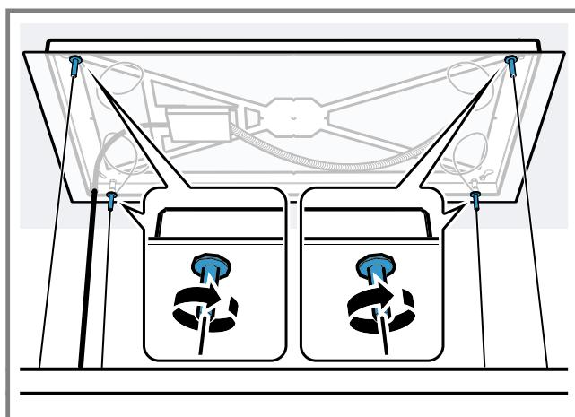
Um die Rahmenabdeckung nicht zu beschädigen, kein Werkzeug verwenden.
