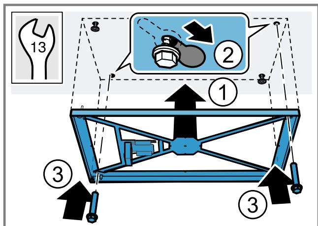
4. Het frame uitlijnen en met twee schroeven vastschroeven.
