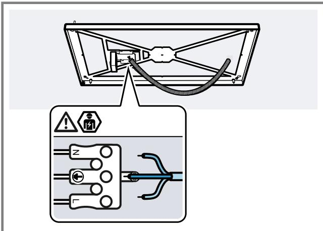
3. De 4 kabels in de sluitmoeren inbrengen.
