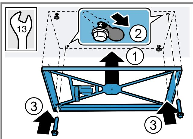
4. Allineare il telaio e serrarlo con due ulteriori viti.
