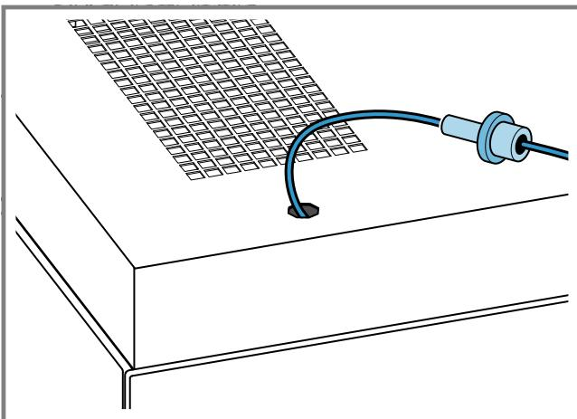
Afin de ne pas endommager l'interrupteur de fin de course de l'appareil, n'insérez pas les bouchons d'obturation dans les ouvertures.
