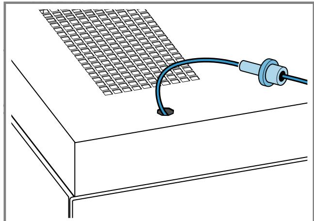
Um den Endschalter des Geräts nicht zu beschädigen, die Verschlussmuttern nicht in die Öffnungen stecken.
