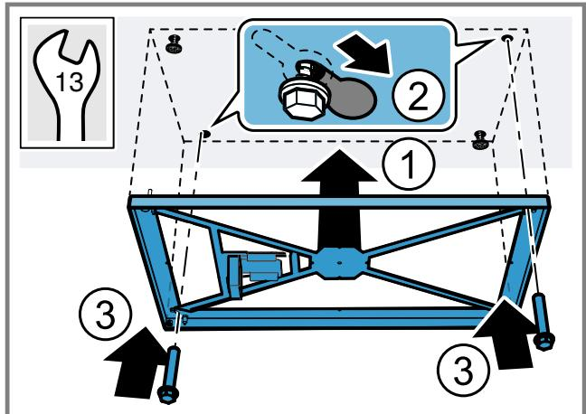
4. Den Rahmen ausrichten und mit zwei Schrauben festschrauben.
