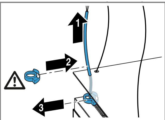
**9.** Die vier Seile in die Seilspanner einfädeln und gleichmäßig spannen.
