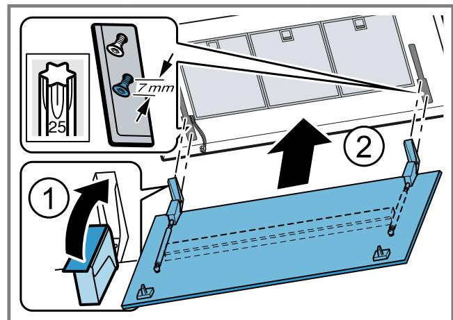
3. Die Befestigungsschrauben der Scharniere festziehen.
