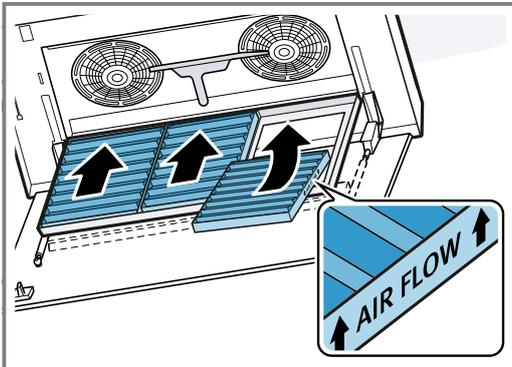
Den Geruchsfilter in korrekter Richtung einsetzen.
