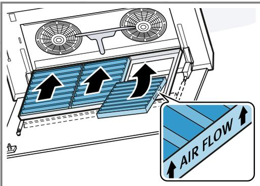
Den Geruchsfilter in korrekter Richtung einsetzen.
