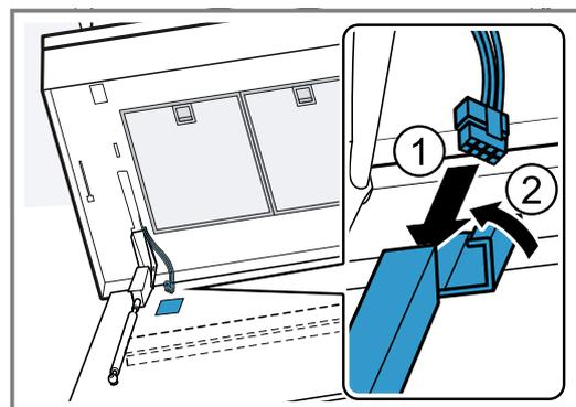
5. Den Deckel des Kabelkanals schließen.
