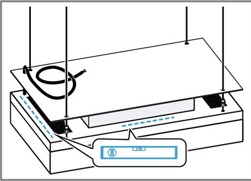
13. Die Schutzfolie vom Gerät entfernen.
