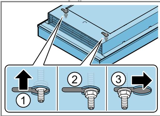
6. Die diagonal gegenüberliegenden Bundmüttern vorsichtig festziehen, bis das Gerät flächenbündig an der Decke anliegt.
