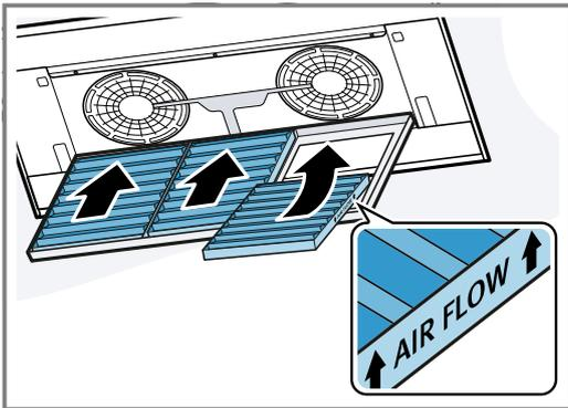
Den Geruchsfilter in korrekter Richtung einsetzen.
