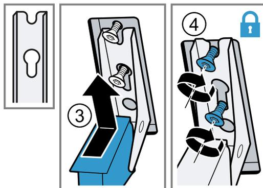
3. Die Befestigungsschrauben der Scharniere festziehen.
