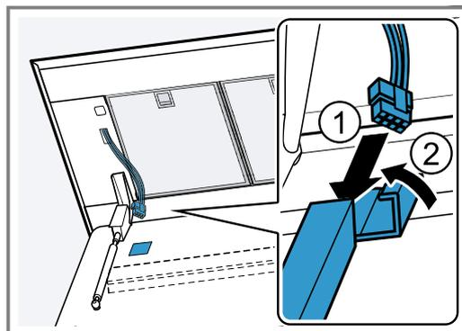
5. Die Filterabdeckung nach oben klappen und einrasten.
