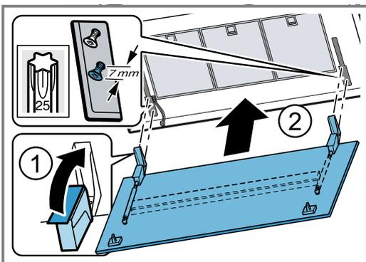
2. Die Filterabdeckung an den vorgesehenen Schrauben einhängen und je nach Schlüsselochöffnung nach hinten/vorne in die Engstelle schieben.
