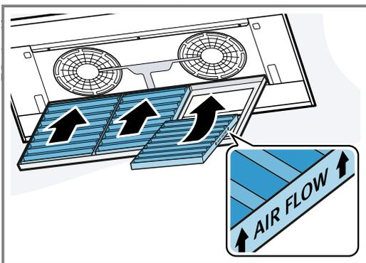
Den Geruchsfilter in korrekter Richtung einsetzen.
