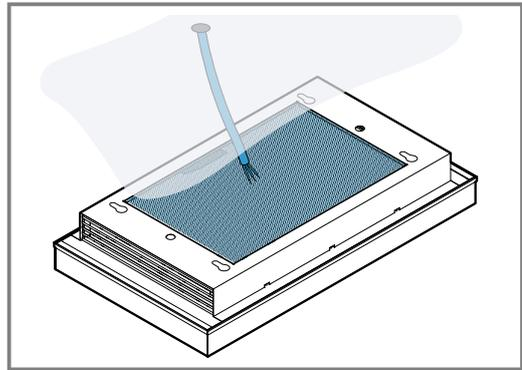
3. Das bauseitige Kabel durch die Öffnung führen und das Gerät in die Befestigungsschrauben an der Decke einhängen.
