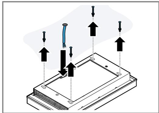
4. Das Gerät bis zum Anschlag in die 4 Schlüsselochöffnungen mit den Führungshülsen einschieben.
