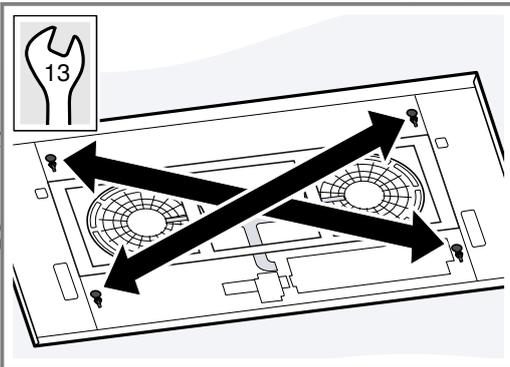
16. Das Gerät aus der Schlüssellochöffnung lösen.
